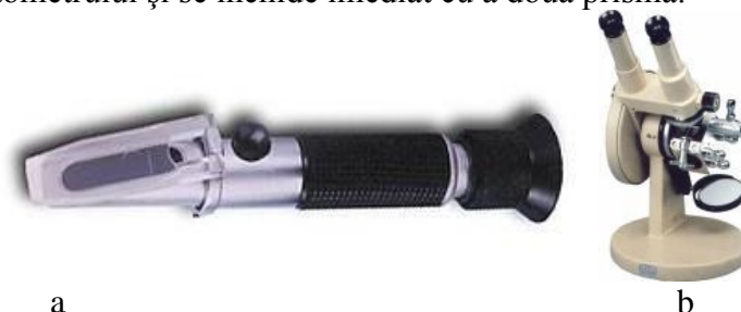
Fig. 4.10. a. Refractometrul portabil ABBE; b. Refractometrul fix WAJ
