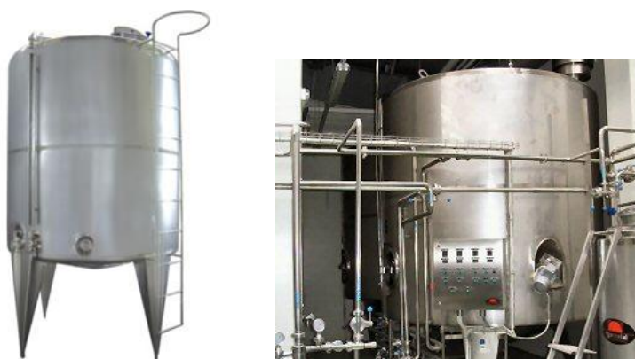
Fig. 12.11 Rezervoare tip tanc vertical depozitarea temporară a laptelui la fabrică
