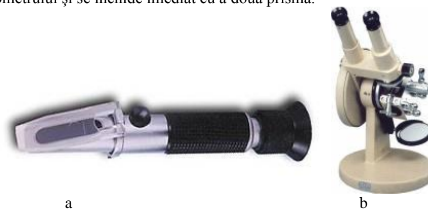
Fig. 4.7. a. Refractometrul portabil ABBE. b. Refractometrul fix WAJ
