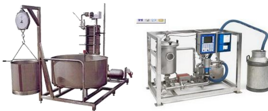
Fig. 12.6 Stații de recepție cantitativă a laptelui
