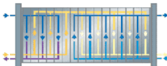
c. Fig. 12.9 Moduri de realizare a răcirii laptelui în răcitoarele cu plăci
