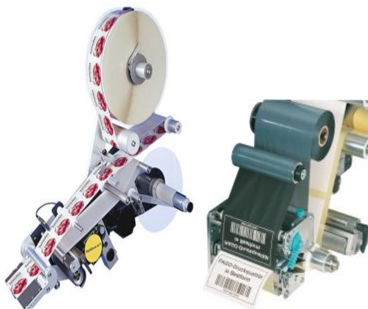
Fig. 9.4. Mașină automată de etichetat cu etichete autoadezive. Mașină de inscripționare etichete
