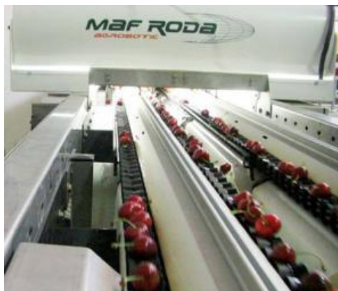
Fig.13.3 Linie automată de sortare legume fructe
