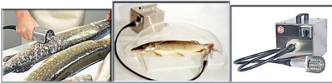
Fig. 11.28 Desolzirea mecanică a peștelui
