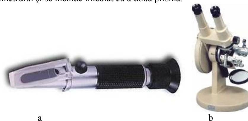
Fig. 1.13. a. Refractometrul portabil ABBE. B. Refractometrul fix WAJ
