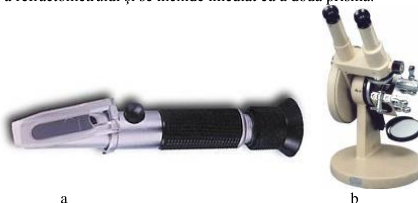
Fig. 4.17. a. Refractometrul portabil ABBE . B. Refractometrul fix WAJ
