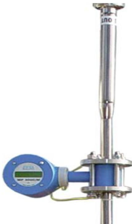
Fig. 12.5 Galactometru montat pe fluxul de alimentare cu lapte
