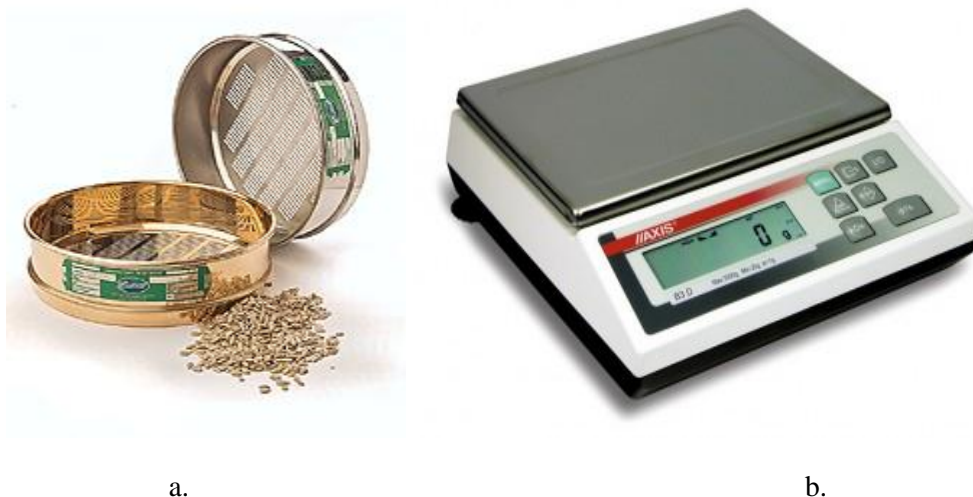
Fig. 4.2 a. Ciur folosit pentru analiza impurităților[1]; b. Balanță tehnică[2]
