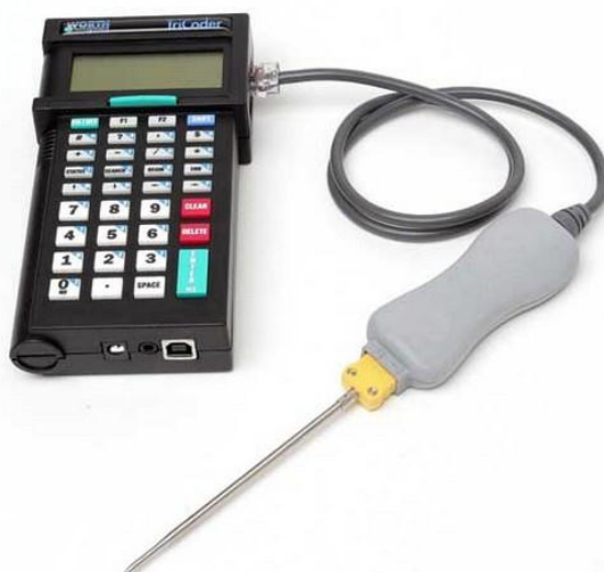
Fig. 4.23 Sondă pentru măsurarea temperaturii cărnii
