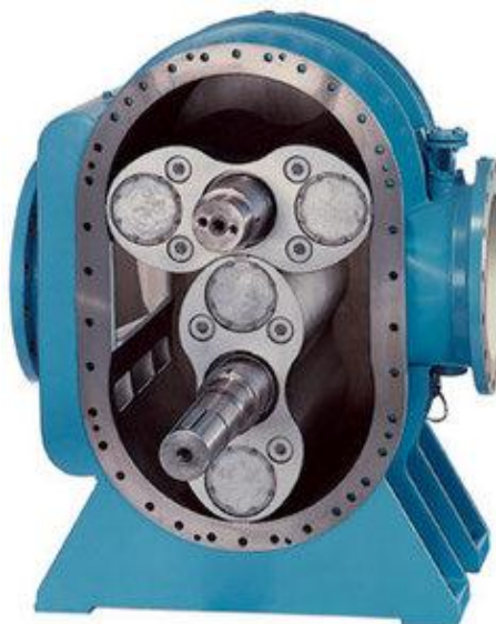
Fig. 5.3 Suflantă cu pistoane rotative [13]
