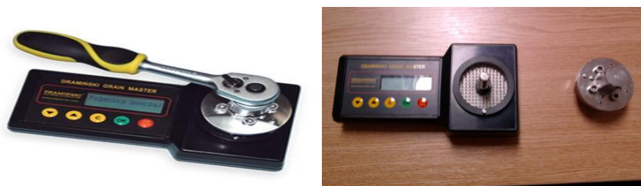
Fig. 4.4. Umidometrul portabil Draminski Grain Master
